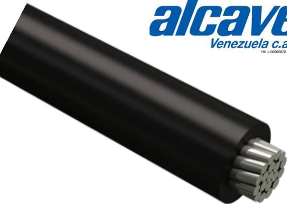
**Construcción:** Conductor de aleación de aluminio serie 8000, cableado clase B compactado. Aislado con compuesto libre de halógenos, baja emisión de humos y retardante a la llama.
