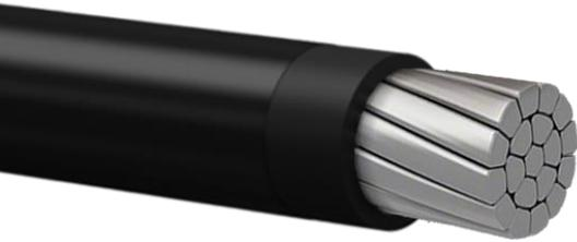
**Construcción:** Conductor de aleación de aluminio AA8000, cableado clase B compactado, aislado con PVC 90°C y recubierto con una capa de Nylon.
